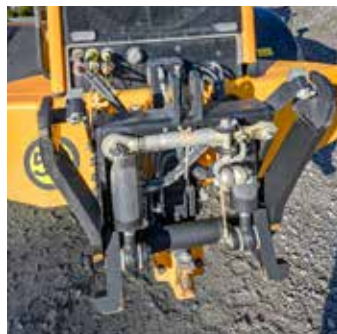
Maskin & Mekan har valt att utrusta sin Ljungby L15 med trepunktslyft för exempelvis en isrivare monterad bak.
