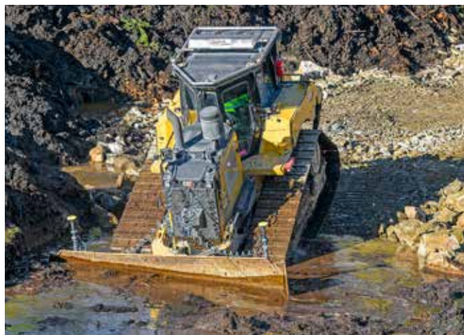
Berg i ena änden och sankmark i den andra. Per Ek kör Maskin & Mekans Cat D6 XE när han skjuter ner fyllet i surhållet.
