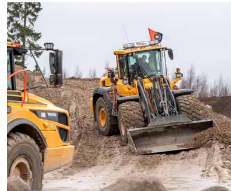
Det kan bli spännande möten när det är maskintensivt på en byggarbetsplats. Här möter Erik Jardeling en av dumprarna när han är på väg ner med sin nya Volvo L120H med Leica maskinstyrning.
